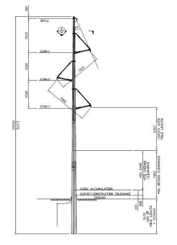
1CCT 230kV TRANSMISSION LINE MOND STEEL TANGENT (0 - 2°) LEFT-RIGHT-LEFT CONFIGURATION FRAMING
